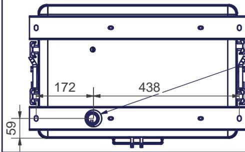
\*) Abmessungen des Schalldämmgehäuses, überstehende Teile wie Verschlüsse, Fittinge etc. sind nicht berücksichtigt
